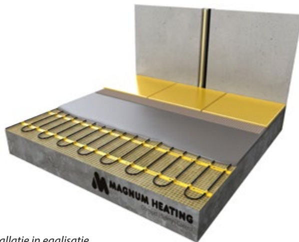
Installatie in egalisatie
