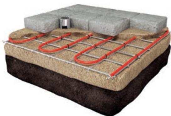
Installatie in zandbed onder klinkers
