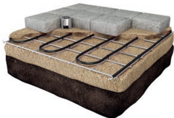
Installatie in zandbed onder klinkers
